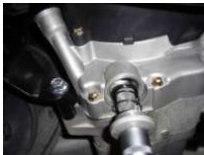
Рис. 11 Контроль уровня масла и замена масляного фильтра
