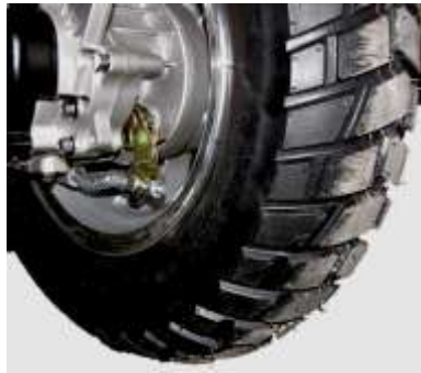
Рис. 14 Регулировка заднего тормоза и картер редуктора
