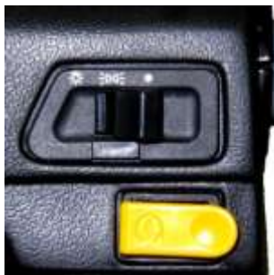
Рис. 7 Блок переключателей на руле правый
