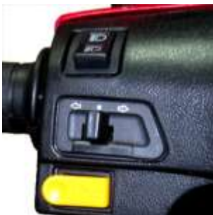
Рис. 6 Блок переключателей на руле левый
