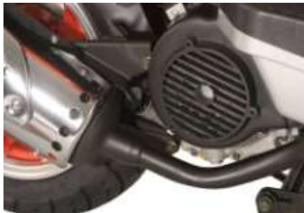
Рис. 11 Контроль уровня масла и замена масляного фильтра
