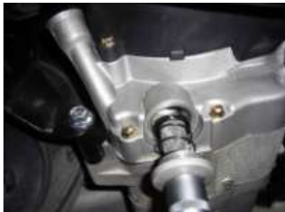
Рис. 11 Контроль уровня масла и замена масляного фильтра
