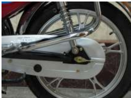
Рис. 16 Регулировка заднего тормоза и натяжения цепи
