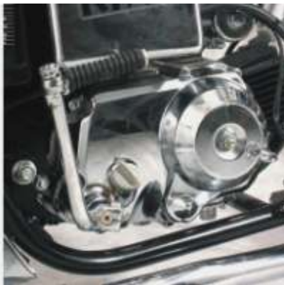
Рис. 13 Щуп контроля уровня масла в двигателе и пробка сливного отверстия
